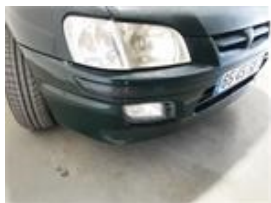
Detalhe dos Danos : Pára-choques_frente Tipo de Danos : Raspado +defeito pintura Tamanho dos Danos : Ver Imagem
