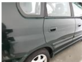
Detalhe dos Danos : Lateral_dir Tipo de Danos : Raspado +mossas Tamanho dos Danos : Ver Imagem
