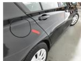
Detalhe dos Danos : Porta_detrás_direita Tipo de Danos : Raspado +mossas Tamanho dos Danos : Ver Imagem
