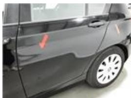
Detalhe dos Danos : Porta_detrás_ilharga-esquerda Tipo de Danos : Raspado +mossas Tamanho dos Danos : Ver Imagem
