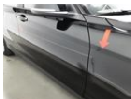
Detalhe dos Danos : Guarda-lamas_porta-frente_direita Tipo de Danos : Raspado +mossas Tamanho dos Danos : Ver Imagem
