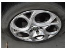
Detalhe dos Danos : Jantes Tipo de Danos : Raspado Tamanho dos Danos : Ver Imagem
