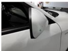
Detalhe dos Danos : Espelhos Tipo de Danos : Raspado Tamanho dos Danos : Ver Imagem
