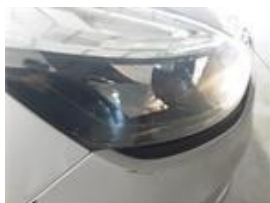
Detalhe dos Danos : Farol_frente_direita Tipo de Danos : Raspado Tamanho dos Danos : Ver Imagem
