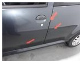
Detalhe dos Danos : Lateral_esq Tipo de Danos : Raspado +vincado Tamanho dos Danos : Ver Imagem
