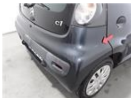
Detalhe dos Danos : Pára-choques_traseiro Tipo de Danos : Riscos Tamanho dos Danos : Ver Imagem
