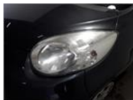
Detalhe dos Danos : Faróis Tipo de Danos : Baços Tamanho dos Danos : Ver Imagem
