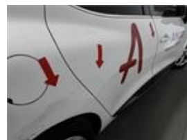
Detalhe : Porta_detrás_ilharga-direita Tipo : Raspado +mossas Ampliar imagem : Ver Imagem
