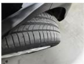
Damage Detail : Pneus-frt Damage Type : C/ desgaste Damage Size : Ver Imagem
