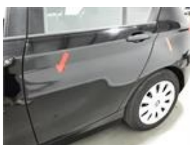
Damage Detail : Porta_detrás_ilharga-esquerda Damage Type : Raspado +mossas Damage Size : Ver Imagem
