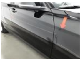
Détail du dommage : Guarda-lamas_porta-frente_direita Type de dommage : Raspado +mossas Taille du dommage : Ver Imagem
