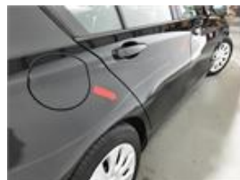
Détail du dommage : Porta_detrás_direita Type de dommage : Raspado +mossas Taille du dommage : Ver Imagem
