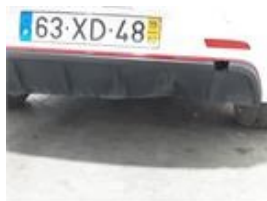
Détail du dommage : Pára-choques_traseiro Type de dommage : Partido Taille du dommage : Ver Imagem
