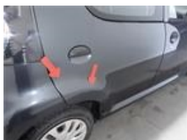
Détail du dommage : Porta_detrás_direita Type de dommage : Riscos +Raspado +mossa pq Taille du dommage : Ver Imagem
