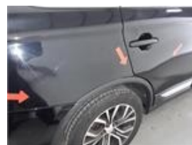
Détail du dommage : Lateral_drt Type de dommage : Riscos superficiais Taille du dommage : Ver Imagem
