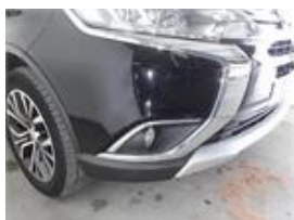
Détail du dommage : Pára-choques_frente Type de dommage : Raspado Taille du dommage : Ver Imagem
