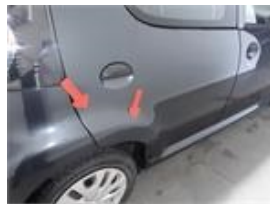
Daño : Porta_detrás_direita Tipo de daño : Riscos +Raspado +mossa pq Gravedad : Ver Imagem
