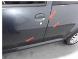
Daño : Lateral_esq Tipo de daño : Raspado +vincado Gravedad : Ver Imagem
