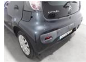
Daño : Pára-choques_traseiro Tipo de daño : Raspado Gravedad : Ver Imagem
