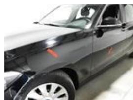
Damage Detail : Guarda-lamas_porta-frente_esquerda Damage Type : Raspado +mossas Damage Size : Ver Imagem
