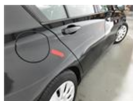
Damage Detail : Porta_detrás_direita Damage Type : Raspado +mossas Damage Size : Ver Imagem
