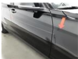
Damage Detail : Guarda-lamas_porta-frente_direita Damage Type : Raspado +mossas Damage Size : Ver Imagem
