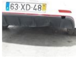
Damage Detail : Pára-choques_traseiro Damage Type : Partido Damage Size : Ver Imagem
