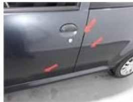
Damage Detail : Lateral_esq Damage Type : Raspado +vincado Damage Size : Ver Imagem
