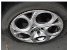
Damage Detail : Jantes Damage Type : Raspado Damage Size : Ver Imagem
