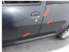
Damage Detail : Lateral_esq Damage Type : Raspado +vincado Damage Size : Ver Imagem
