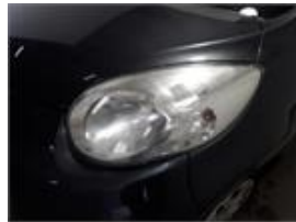
Damage Detail : Faróis Damage Type : Baços Damage Size : Ver Imagem
