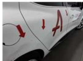
Damage Detail : Porta_detrás_ilharga-direita Damage Type : Raspado +mossas Damage Size : Ver Imagem
