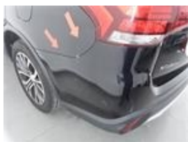
Damage Detail : Pára-choques_traseiro Damage Type : Raspado +mossas pq Damage Size : Ver Imagem
